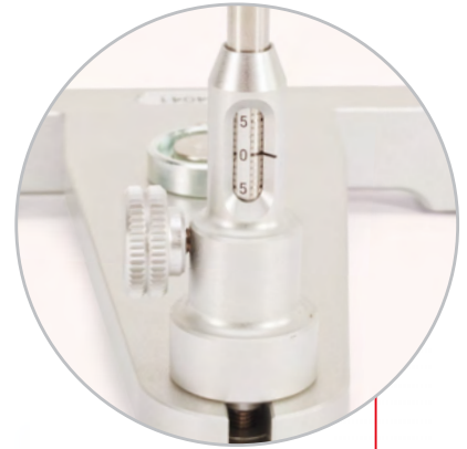
目盛付きのインサイザルピン Incisal Pin with Scale
