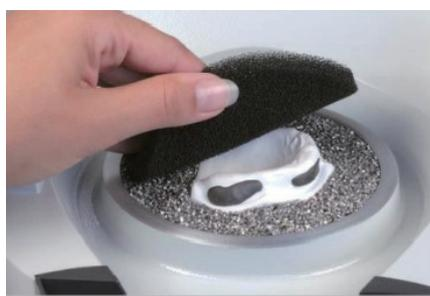
**STEP2** 約1cm厚のカットスポンジを水で湿らせて模型の上に被せ、選択したプレートをプレスします。
