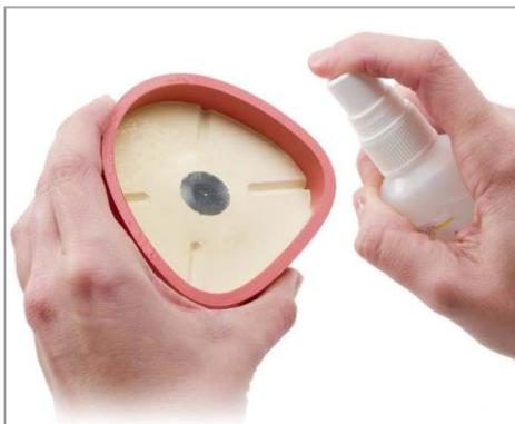
1. スプリットキャストフォーマーのみを取り外し、石膏分離材を塗布します。その後、マグネットを入れたホールディングカップをアドヒージョンプレートにくっつけてください。
