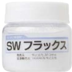
ペーストタイプのフラックスで、鑑着時の濡れ性の向上と、金属表面の酸化膜や汚れを除去し、銀ろうの流れをスムーズにします。活性温度は、400-900℃です。
