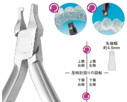
カンタークックワイスウェッジプライヤーは、特定の歯牙に対して頬側面とその反対側の舌側面の隅角で、アライナーに楔形のくぼみを作ることで、回転応力を生じさせるために使用されるインスツルメントです。反時計回りに回転させる際に使用されます。
