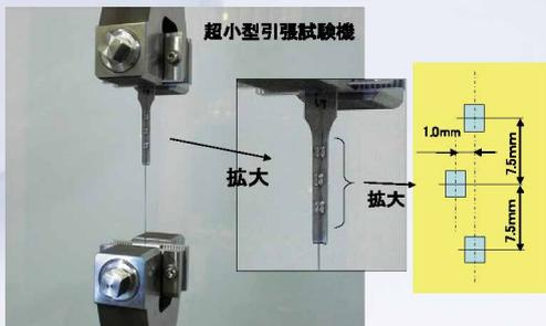
\*ブリッジの間隔、ずれの長さを種々に変えた試験を行って、最適な寸法を決定
