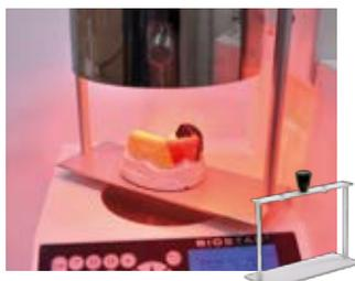
対合歯の圧痕を付与するため、ヒーティングサポートを用いて咬合面を加熱します。
