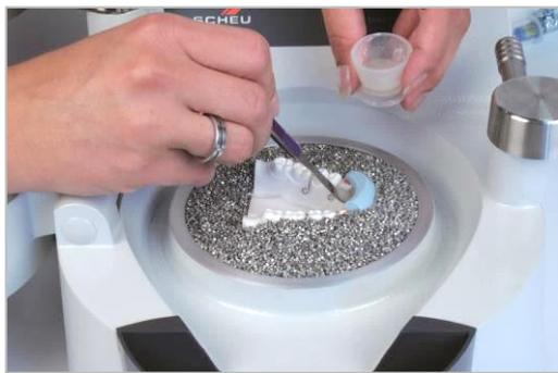
通例によってプレートを加熱します。加熱時間が残り 20~30 秒ぐらいになったら、オーソクリスタルレジン的人工歯の歯根部とクラスプ線の口蓋部を被っている部分に盛り付けます。指定加熱時間経過後、通法によりチャンバーを閉じて加圧、冷却、排気します。バイオクリル C は、オーソクリスタルレジンと重合し、一体化します。
