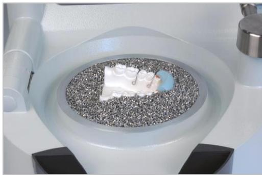
模型の基底面を平らにし、モデルプラットフォーム上にセットします。イソフォランフィルムを模型上にプレスし (P5 参照)、余剰部を模型の基底面に沿ってカットします。次に、あらかじめベンディングしておいたクラスプ線を、イソフォランフィルムの上からスティッキーワックスで固定します。この時、模型の頬側にワックスを塗布するようにしてください。(舌側に塗布するとワックスがプレートを汚してしまうため)
