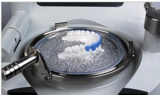
通法によりプレートを加熱、加圧し、冷却、排気します。
