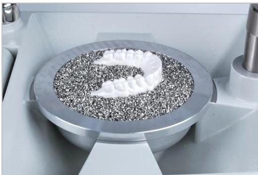
イソフォランフィルムを付けたまま、模型をステンスペレットでモデルカップに埋没し、選択したプレートを通法により指定時間加熱、加圧し、冷却、排気します。
