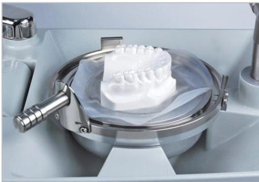
模型の基底面を平らにし、モデルプラットフォーム上にセットします。通法(P5 参照)によりイソフォランフィルムをプレスし、余剰部を模型基底面でカットします。
