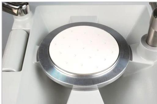
専用の台紙(プリスターカートン)をモデルプラットフォーム上にセットします。模型の基底面を平らにし、セットした台紙の上に乗せます。
