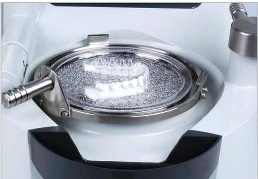
モデルプラットフォームを取り外して、ペレット埋没法で模型をセットします。選択したプレートを通法により加熱、加圧し、冷却、排気します。
