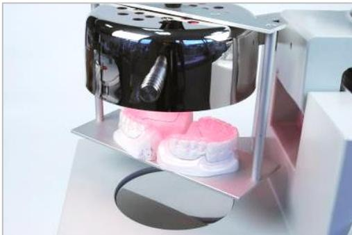
バイオスターやミニスターを「マウスガードモード」に設定します。(設定方法は取扱説明書をご覧ください。)専用のヒーティングサポートをヒーターにセットして模型を置き、上下顎の咬合面を加熱します(ヒーターと咬合面の距離は約 10cm)。3~4 分間加熱後、上下顎模型を素早く咬合器やその他の固定器(フィグゼーター)にセットし、上下顎をゆっくりと合着させます。この時、呼吸孔を作るために長方形に切ったコピープラスト C 2.0mm を上下顎の前歯部の間に挟みます。(呼吸孔は後で開けることも可能です。)素材が軟化しているうちに、濡らした指で上下顎の舌側の境目を滑らかに整えます。
