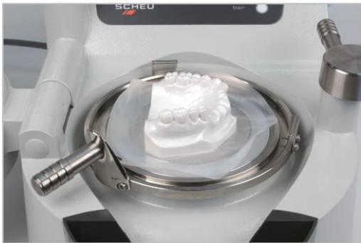
模型の基底面を平らにし、モデルプラットフォーム上にセットします。イソフォランフィルムを模型上にプレスし(P5 参照)、余剰部を模型の基底面に沿ってカットします。人工歯(レジン歯)の歯牙の基底部にスティッキーワックスを施し、イソフォランフィルム上の欠損部分に植立します。
