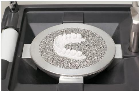
模型をステンスペレットに左写真のように埋没します。模型を低くトリミングした場合は、モデルプラットフォーム上にセットします。
