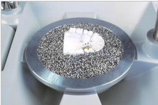
模型上のスクリューを位置付けたい場所にスロットを掘ります。また、クラスプ線を曲げて用意し、一度クラスプ線を全て模型から外します。模型の基底面を平らにしてモデルプラットフォームに乗せ、通法(P5参照)によりイソフォランフィルムをプレスし、余剰部を模型の基底面でカットします。スカルペルを用いて歯間部や口蓋部に切り込みを入れ、エアーの抜け道を作ります。ワックスやシルキットをスロット内に少量入れておき、エキスパンションスクリューのタグをスロットに差し込みます。反対側(上部)のスペーサーはプレートの圧接時に干渉するため、バーなどで切除してください。クラスプ線を模型に戻し、頬側にスティッキーワックスで(イソフォランフィルム上に)固定します。左の写真のように、模型の咬合平面がモデルカップの縁と水平になるように、模型をステンレスプレートに埋没します。舌側の大きなアンダーカットは、ブロッキングアウトパテまたはシルキットなどでブロックアウトしておいてください。
