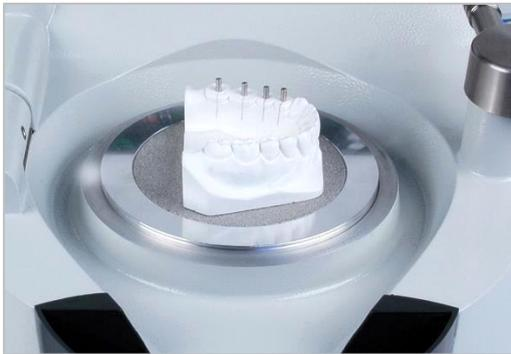
ワックスアップされた模型の複模型を作ります。インプラント対象歯牙のオクルーザルエリアまたはインサイザルエリアをスムーズに削り、穴を開けてチタン製のピンを植立します。模型の基底面を平らにし、モデルプラットフォームに乗せます。通法(P5 参照)によりイソフォランフィルムを加熱、加圧し、冷却、排気します。余剰部を模型基底面でカットし、インプラント対象歯牙の部分を切り抜きます。
