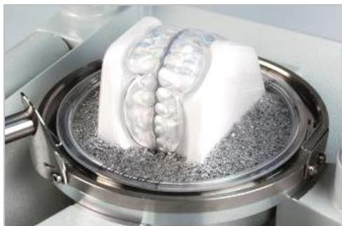
2mm のバイオプラストを、通法により加熱、加圧し、冷却します。冷却時間終了後、約1分待って排気し、模型を取り出します。
