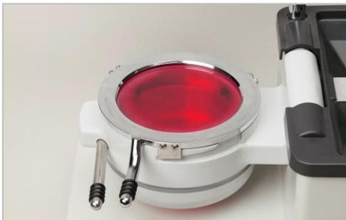
ブラックスチェッカーシートの、赤色コーティングされた面が下(対合歯側)になるようにシートを取り付け、通法により加熱、加圧し、冷却、排気します。
