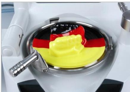
模型の基底面を平らにした模型を準備し、通法に従ってバイオプラストを加熱します。加熱時間が残り 30 秒ぐらいになったら、模型の必要部分にバイオプラスト分離材を塗布して余剰分をエアで飛ばした後、模型をモデルプラットフォーム上にセットし、プレス、冷却、排気します。
