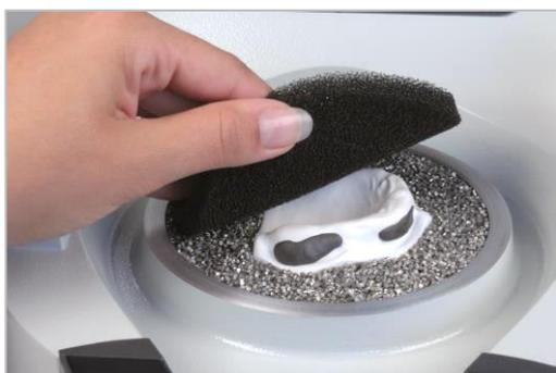
約1cm厚のカットスポンジを水で湿らせて模型の上に被せます。これにより印象材を盛るスペースを確保すると同時に、成形されたトレーの内面をザラザラに仕上げることができます。必要なスペースの量に応じて、カットスポンジは3枚まで重ねて使用することが可能です。
