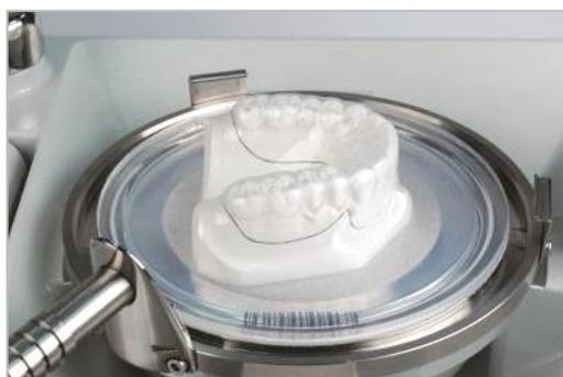
模型の基底面を平らにし、必要なスプリントエリアにバイオプラスト分離材を塗布します。模型をモデルプラットフォームに乗せ、通法によりバイオプラストを加熱、加圧、冷却、排気します。模型を取り出して余剰部をカットし、咬合面全体を切り取り抜きます。(下写真)
