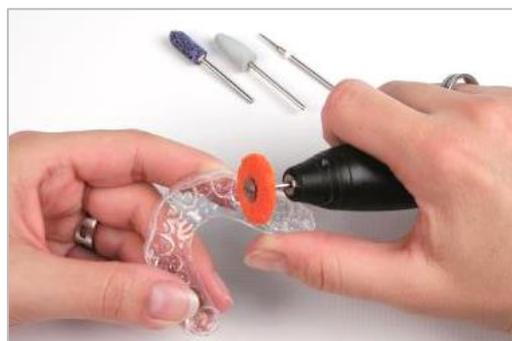
成形されたプレートに放射状に切り込みを入れ、力をかけないように注意深く模型から取り外し、フィニッシングラインで切り取って辺縁を整えて仕上げます。辺縁の仕上げには、デイモプロ(#3381)というオレンジ色のホイールバーが便利です。
