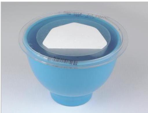
ラバーボール一杯に水を満たしてから、写真のように成形されたモールドシートを乗せ、石膏(又はアクリルレジンなど)を注いで安定させます。ラバーボールの水によって石膏の重さが均等になり、モールドシートの歪みが最小限に抑えられ、より正確な模型の複製ができます。硬化後、模型を取り出してください。
