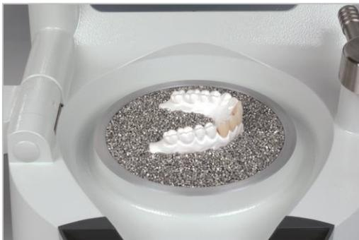
モデルプラットフォームを取り外して、ペレット埋没法(P3 参照)で模型をセットします。この時、人工歯が垂直になるようにセットしてください。(プレートに押されて動いてしまうため)
