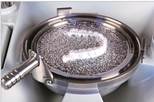
オリジナル模型をステンレスペレットに埋没し、通法によりデュラン（またはデュランプラス）をプレスします。
