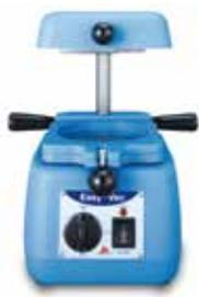
簡単な操作でマウスガードなどを吸引成型する歯科技工用ヒータープレスです。シートの過熱、ヒーターの切り忘れなどを防ぐために、過熱防止タイマーを設けています。ボディは軽量で強度・耐蝕性に優れたアルミニウムキャストを採用したコンパクトな設計です。
