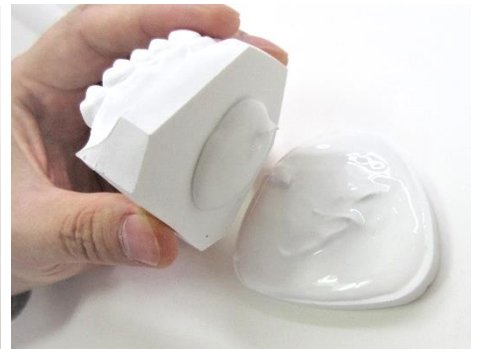
3.模型の基底面にアンダーカットを彫り、インターフェースプレートに乗せる。
