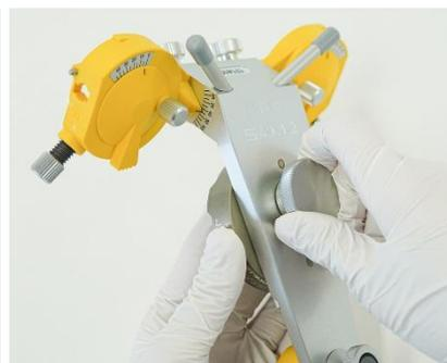
下顎模型弓にはマトリックスホルダーカップのアジャストプレート(シルバーの丸い板)を取り付け、こちらもサムスクリューを固く締めます。
