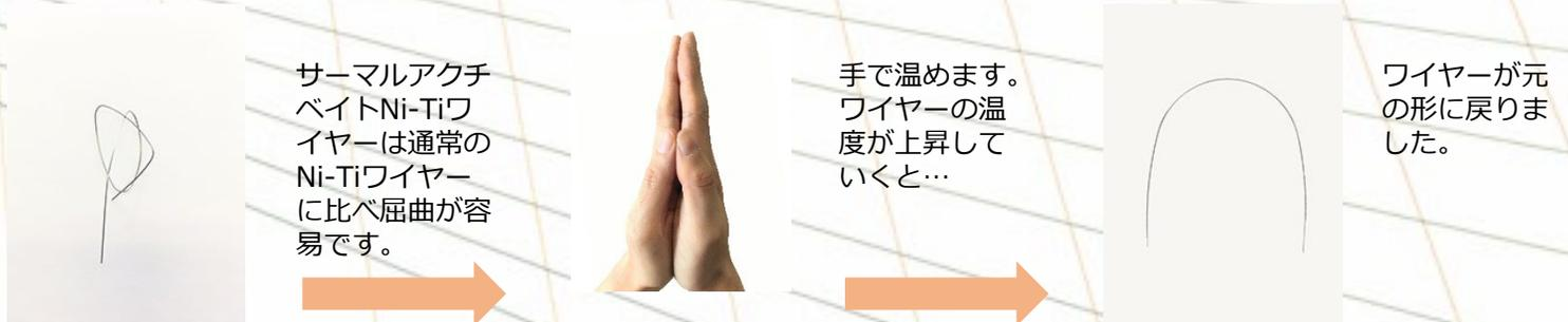
スーパーエラスティックNiTiワイヤーとサーマルアクチベートNiTiワイヤーのたわみ量の比較
