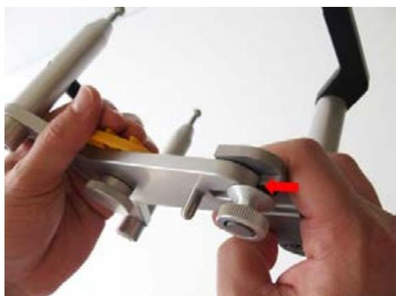
下顎弓からインサイザルピンを取り外し、取り外した箇所にトランスファースタンドを差し込み固定します。
