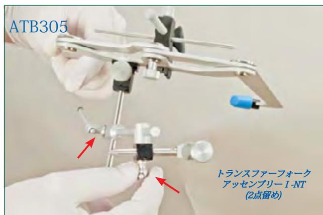
左写真、「トランスファーフォークアッセンブリー I-NT(ATB305)」は、垂直的移動、平行移動のクランプ2点留めタイプです。(赤矢印2カ所)
