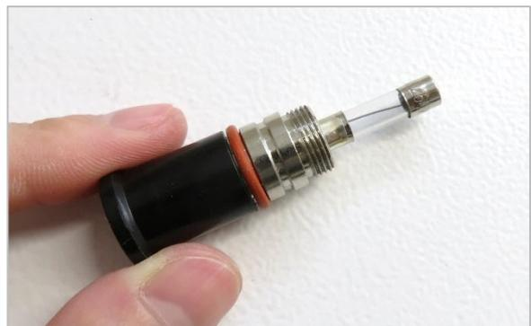
戻すときは上記と逆のステップ(ヒューズボックスを軽く押し込みながら矢印と反対方向に回す)で取り付けてください。
