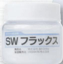
ペーストタイプのフラックスで、ろう着時のぬれ性の向上と、金属表面の酸化膜やよごれを除去し、銀ろうの流れをスムーズにします。活性温度は、400-900℃です。
