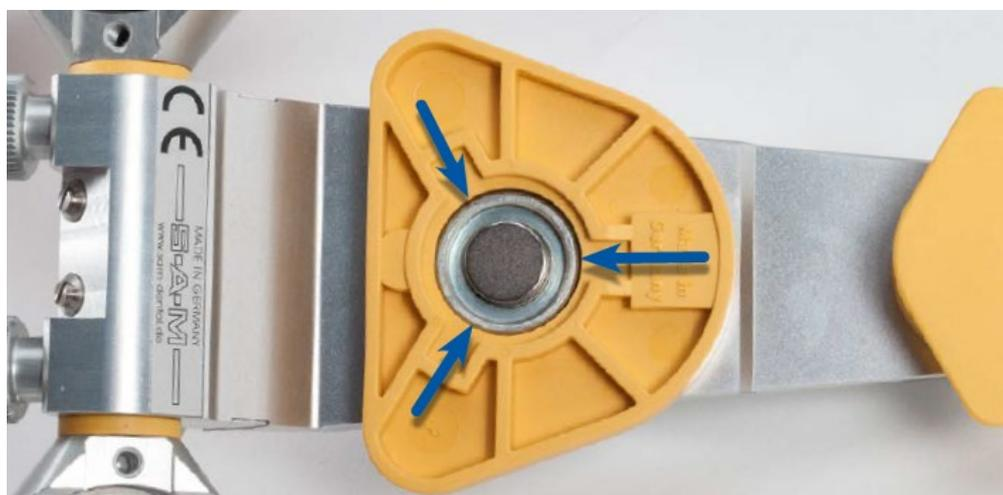
カップポジショナーでポジショニングした状態で、イエローレンチを用いてキャップナットをしっかりと締めます。
