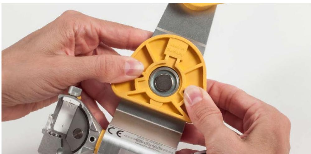
カップポジショナーを使用して、マグネティックホールディングカップの磁石が中央に来るよう微調整します。
