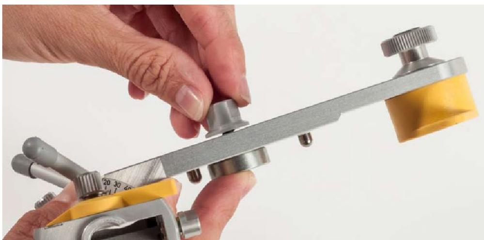
MPS マウンティングプレートをマグネティックホールディングカップに嵌まるようにセットします。
