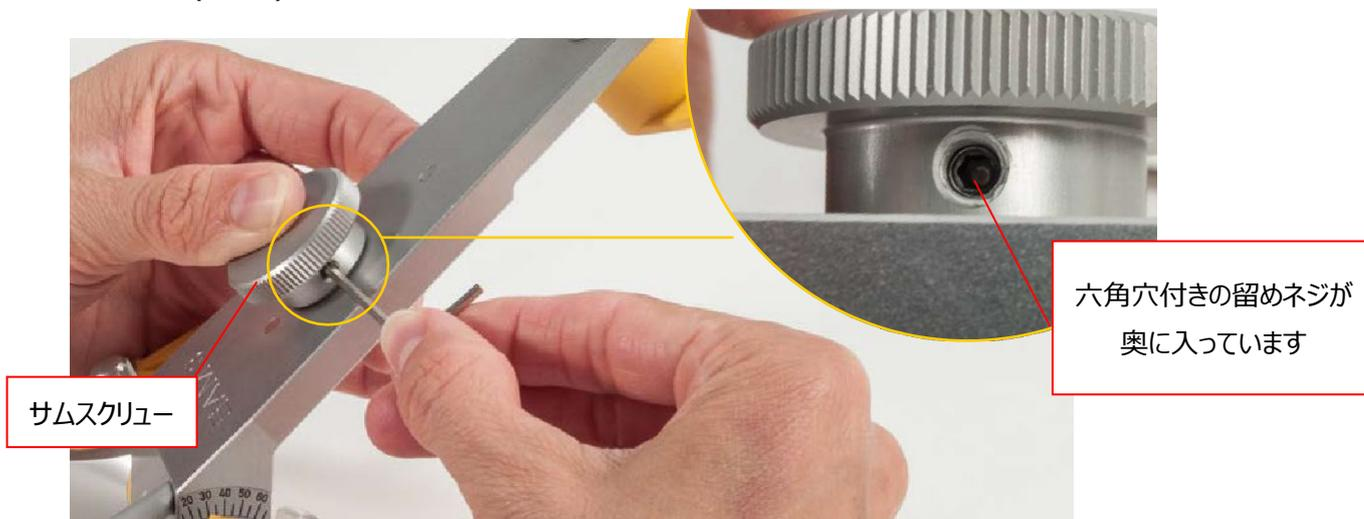
留めネジをしっかり緩め（または完全に抜き取ってください）、ポストを外します。
