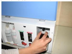
II) 空のボトルをセットしましたら、**ホルマリン原液ボトル**を図の様に差し込んでセットして下さい。
