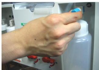
V) 入れて頂きましたら、ホルマリン原液と同じ要領で図の様に**精製水**ボトルをセットして下さい。
