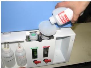
廃液が終了しましたら、コックが**閉**になっている事を確認し、中和液・消臭液を付属のロートを使用し注入して下さい。
