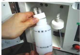
I) 上記写真のようにランプが点灯しましたら、**空のボトル**をセットして下さい。
