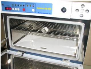
インジケーターは、ホルマリンガス濃度が規定の1500PPM以上に到達して変色します。変色はまばらな時がありますが、薄く変色しておればOKです。
