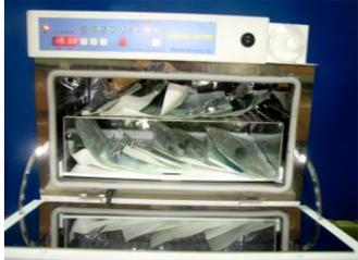
チャンパー(庫内)に入れる対象物の目安は、7割～8割を目安に入れて下さい。(取り出す際に滅菌パックが引っ掛かって取り難いのは×)中段の網棚は外して頂いて結構です。濡れた物、真空状態の物、50℃以上の温度に耐えられない物、また-50kpaの陰圧に耐えられない物は避けて下さい。
