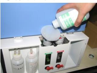
中和液・消臭液共にセットが終了しましたら、リセットボタンを**3秒間**長押しして下さい。表示カウントが元に戻ります・
