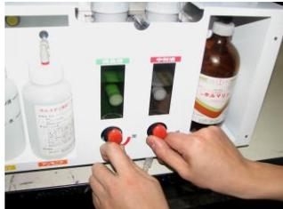
あらかじめタンクのキャップを両方とも外しておきます。中和液槽・消臭液槽の下に、廃液用のコックがあります。これを片方ずつ開くと、下の廃液ドレーンから両方の薬液が出てきます。この薬液を桶に溜めて頂いて、水道水と一緒に廃液下さい。**中和液・消臭液共にPH7の中性**
