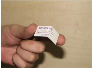
弊社チェックカードは裏側からガスを吸収し、茶色に変化します。なるべくガスを吸収しやすくする為、少し半分に折り曲げた状態で、滅菌パック内、或いは外側に置いて下さい。
