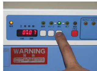
工程が終了した直後は、扉をすぐ開けて頂いて結構ですが、工程終了から時間が経過しているようでしたら、浄化ボタンを押してから開けて下さい。(7分工程)
