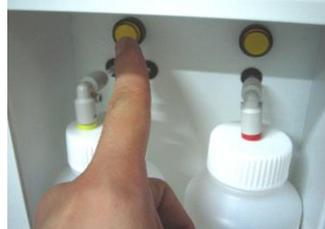
III) **左のボタン**を1度だけ押して頂きます。すると自動的にホルマリン液のボトルラインまで液が充填されます。
