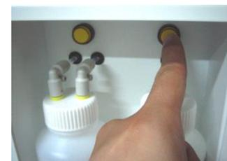
VI) **右のボタン**を1度だけ押して頂きます。すると自動的に精製水のボトルラインまで液が充填します。
