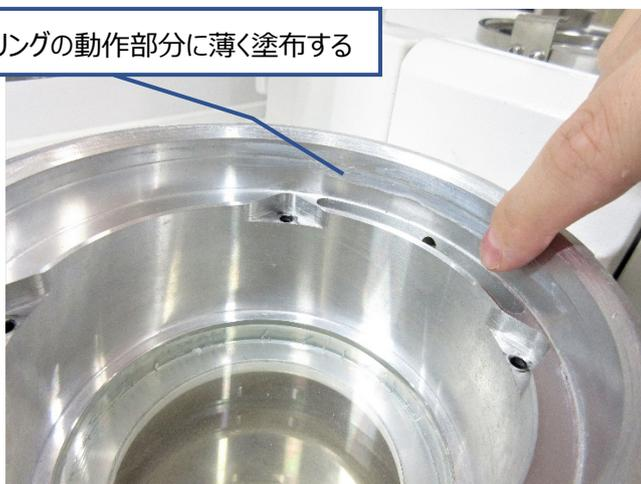
6. スプリングを全てチャンバー内に戻し、3回程プッシュして滑りを確認する
