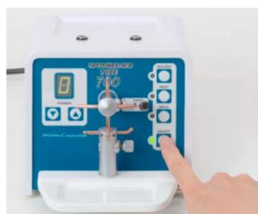
3. 機能選択ボタン「WELD」を押し、スポット溶接モードにします。ボタンの横のランプが点灯します。
