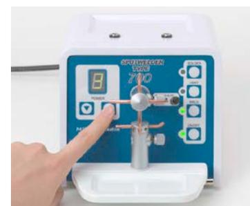
6. トレーを押し下げて、上下のエレクトロードの間を開き、スポットウェルディングするものを間に挟みます。
