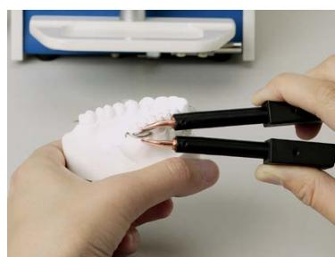
※ウェルディングツイーザーには、SWH108 アッパー・ポイントエレクトロードが標準装備されていますが、使用目的に応じてその他のエレクトロード(別売)と交換することができます。
