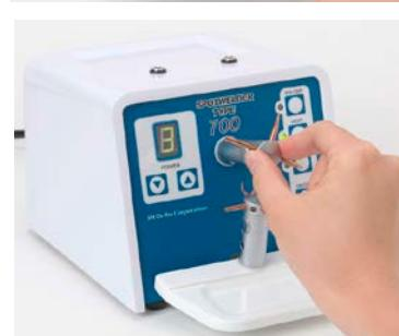
5. 出力調整ボタンを押して出力を調整します。被溶接物の厚さ等によって適当な出力を選んでください。
