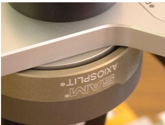
そっと上顎模型弓を下ろして、マスターチェックとの隙間を調べます。平面部は紙一枚が入る隙間がありますのでご注意ください。斜面部が均等に接触していれば OK です。
