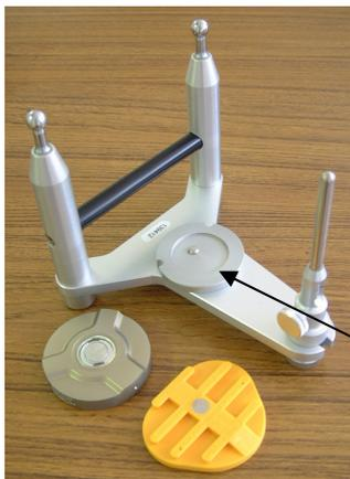
下顎模型弓には ASP540 アキシオスプリットマトリックスホルダーカップのスレッドリング(シルバーの丸い板)を取り付け、これもマウンティングスクリューを固く締めます。
