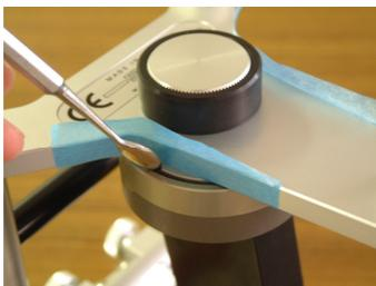
問題がなければ、ASP530 アキシオスプリットマトリックスホルダーのマグネットを戻し、咬合器を再び閉じて倒立させ、ASP540 のマトリックスホールディングユニットとスレッドリングの隙間に練和したキャストパターンレジンを流し込みます。
