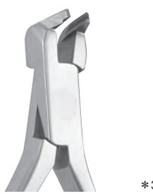
切断許容径：角ワイヤー-.022"×.028"/0.56mm×0.71mm/丸ワイヤー-.020"/0.51mm/ツイストワイヤー-.016"/0.41mm \*3
