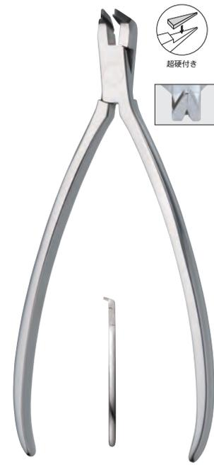
切断許容径：角ワイヤー-.022"×.028"/0.56mm×0.71mm/丸ワイヤー-.020"/0.51mm/ツイストワイヤー-.016"/0.41mm \*3
